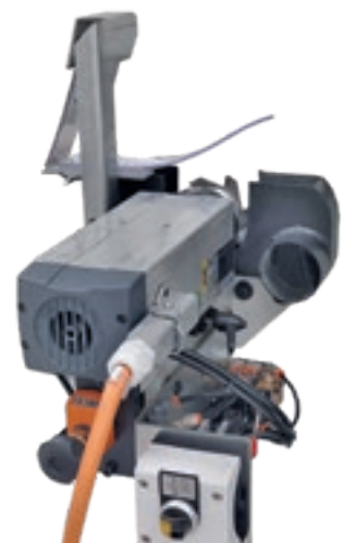
Das Nutaggregat ermöglicht das Nuten und Fräsen auf der unteren Plattenfläche.
